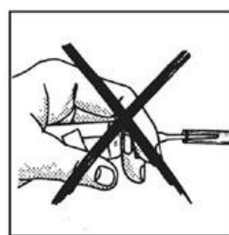
¡INCORRECTO! No mantener el envase en posición horizontal durante la aplicación
